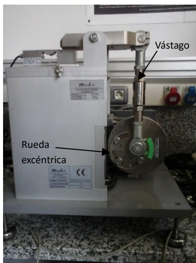
Ilustración 16: Fotografía equipo de fatiga a flexión alternante original
