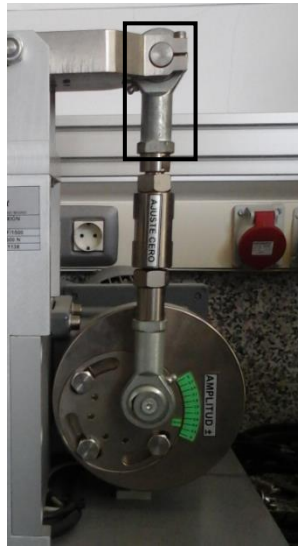
Ilustración 43: Detalle enganche del vástago a modificar
