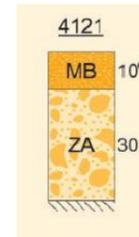
Figura 15. Sección de firme tipo 4121.
