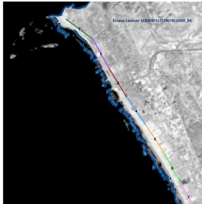
Figura 5.32: Ejemplo de fuentes de error en la línea de costa por oleaje.
