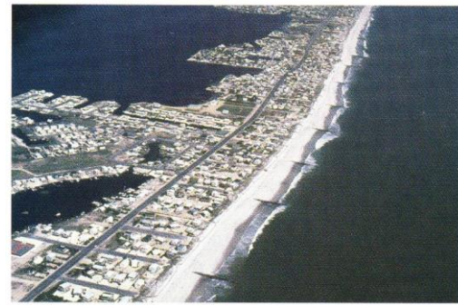
Figura 2.4: Erosión y deposición sobre los espigones. Fuente: Thurman & Trujillo 2002
