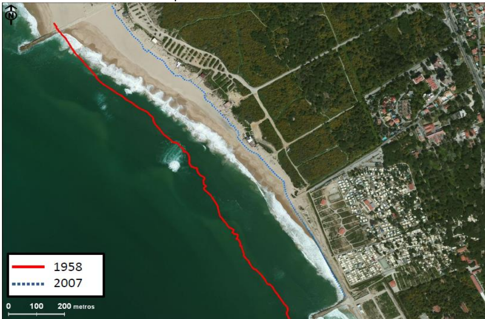
Figura 1.7: Retroceso con magnitud aproximada de 200 metros en la línea de costa. Fuente: Aleixo Pinto 2015
