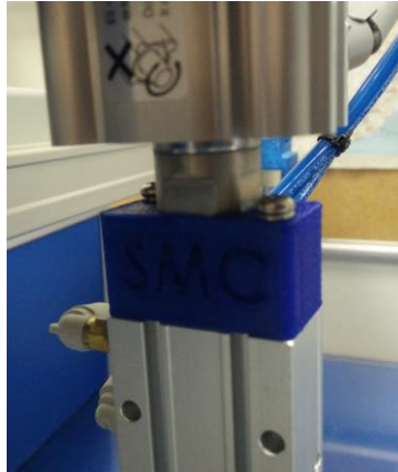
Fig. 76 Pieza de amarre entre el extremo del vástago y la base de la pinza
