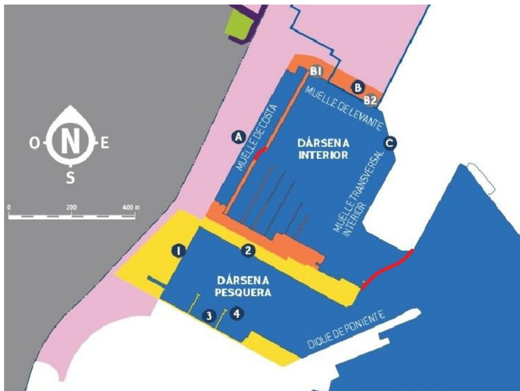
Imagen 6. Propuesta de barreras de contención
