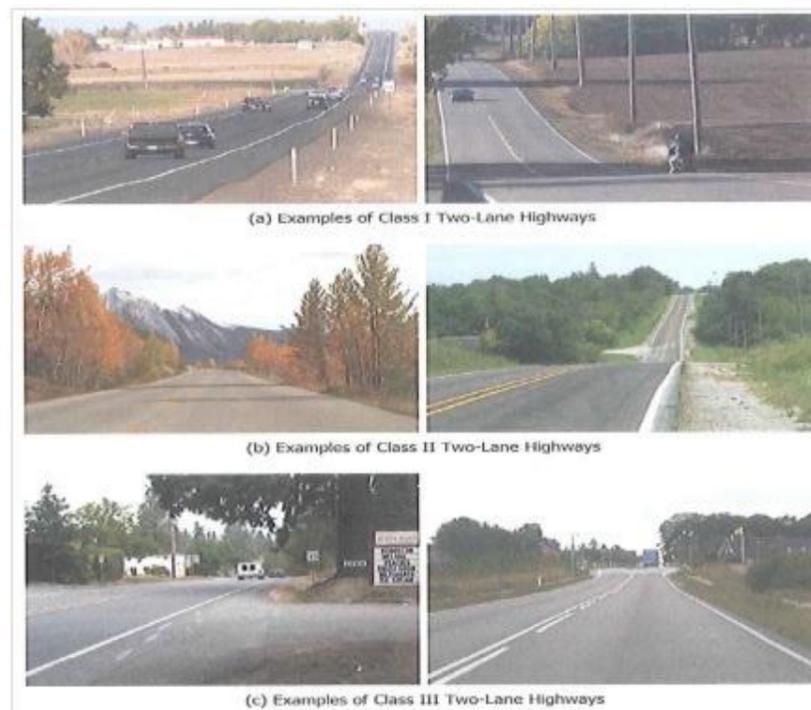
Fig. 16 Clasificación para carreteras de dos carriles. Fuente: *Highway Capacity Manual 2010*
