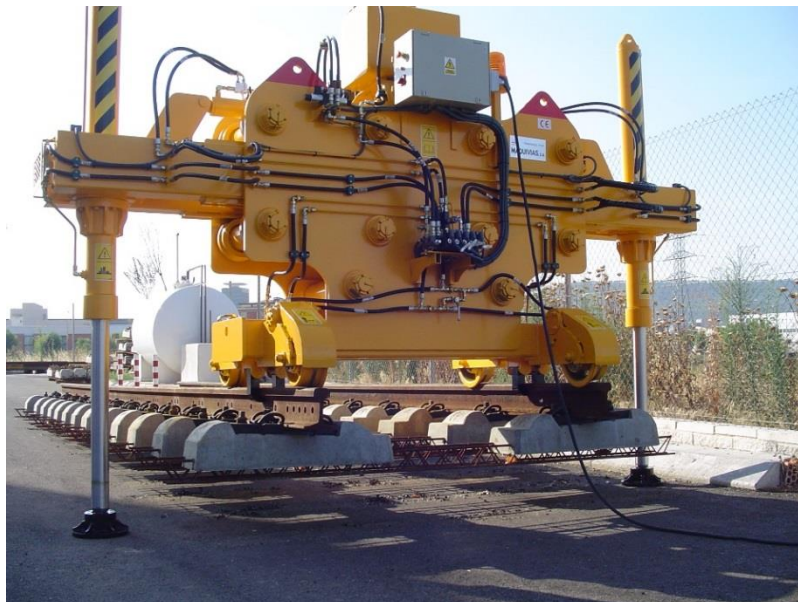
Figura 5.6. Ripado de las vías. Fuente: [82]
