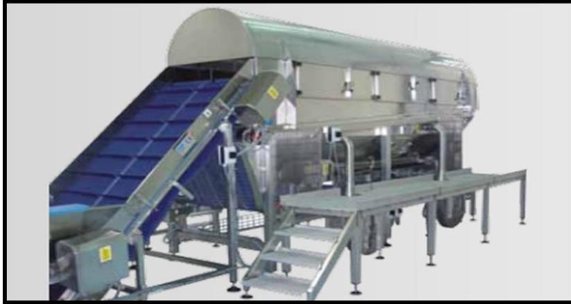
Figura 2: Separador neumático
