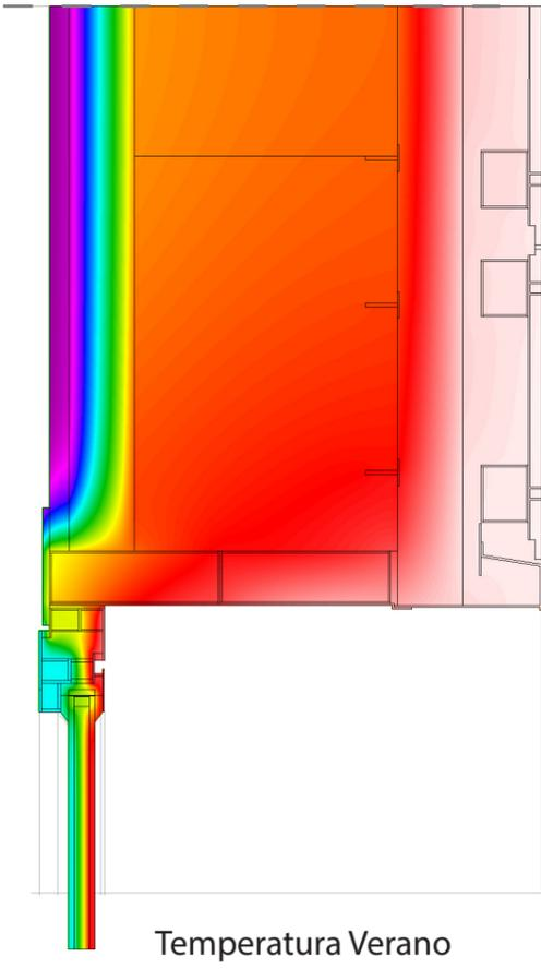
Sección vertical: Perfil del dintel relleno con PUR
