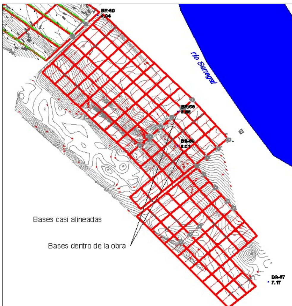
Sector 43; ejemplo de mala disposición de bases.
