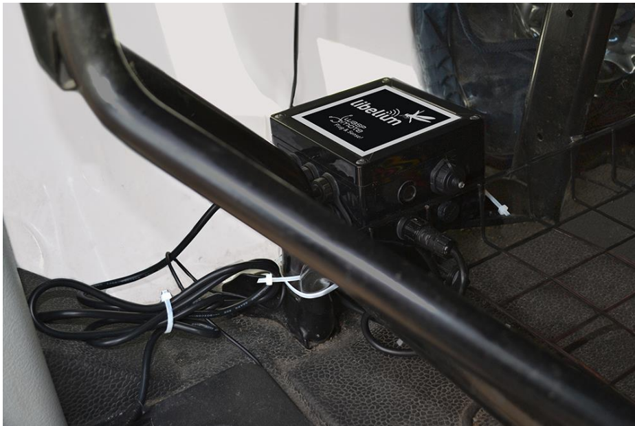
Ilustración 58. Instalación en el coche 1. Fuente: (Libelium, 2015)
