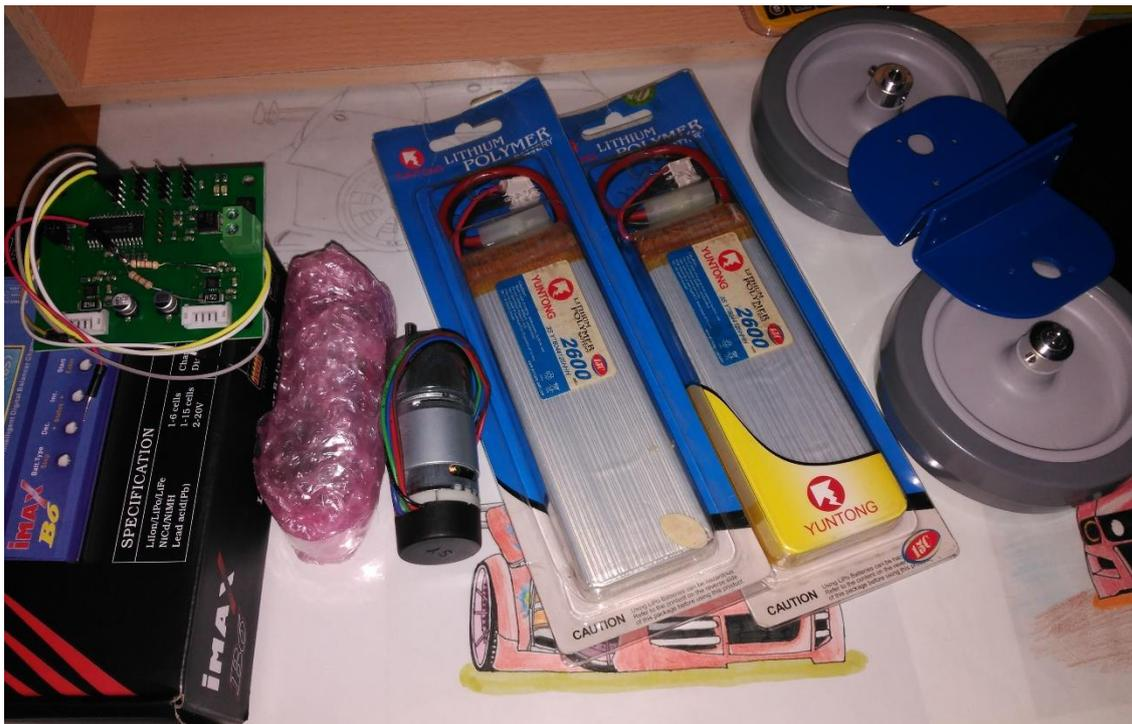
**Figura 32: Kit locomoción y baterías ROVER 2.**
