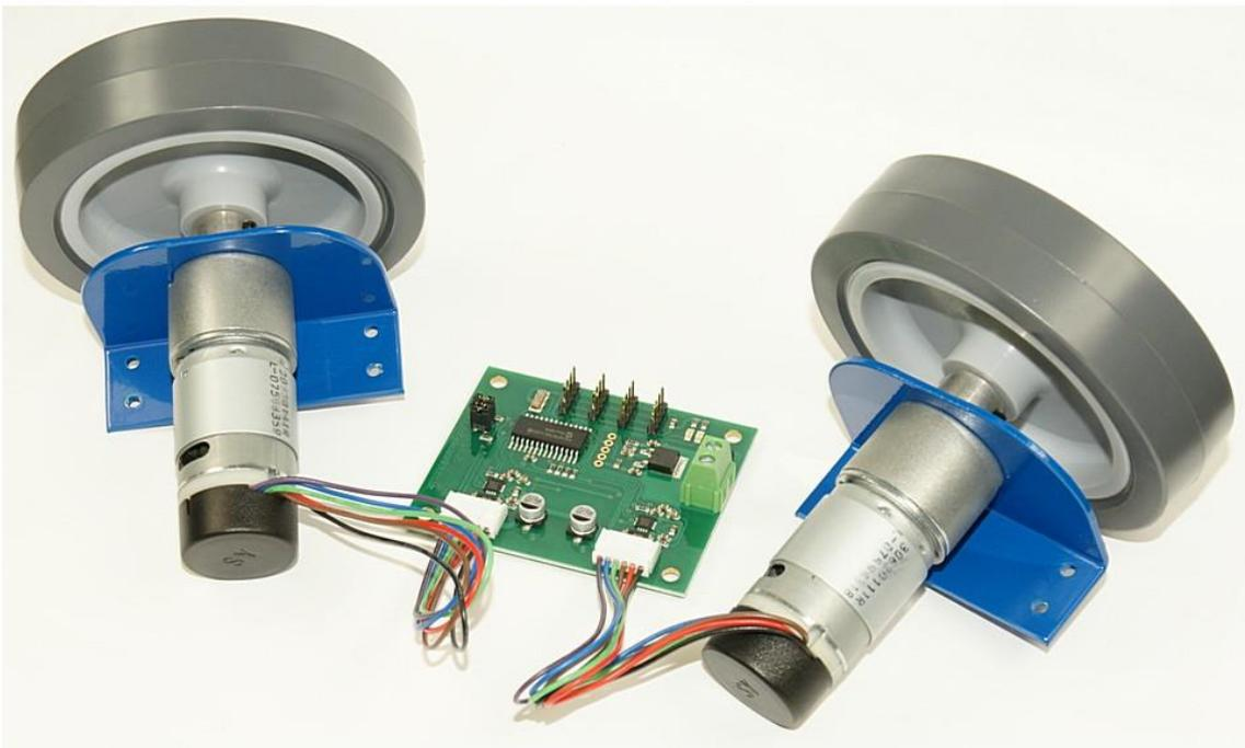
**Figura 31: Kit de locomoción RD02. Fuente: [www.superrobotica.com](http://www.superrobotica.com)**
