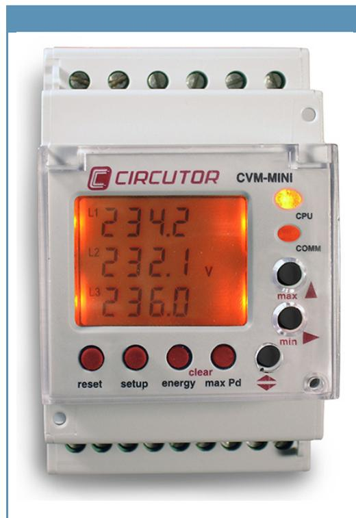
**Figura 16: Analizador de red, Circuitor CVM Mini.**
