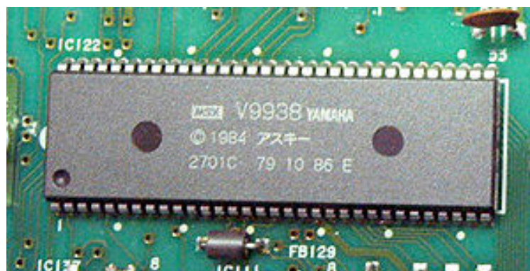
Figura 3.5: Fotografía de un procesador Yamaha V9938 en un MSX2
