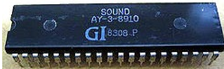
Figura 3.2: Fotografía de un PSG AY-3-8910 en un MSX de primera generación
