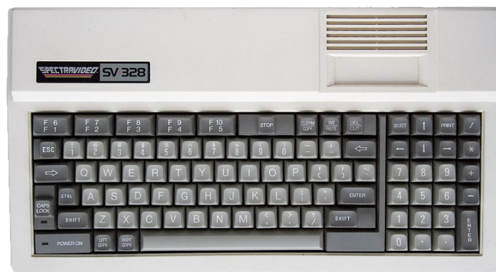
Figura 2.4: Spectravideo SV-328 (1984). Microordenador de 8 bits orientado al mercado más profesional que el Spectravideo SV-318
