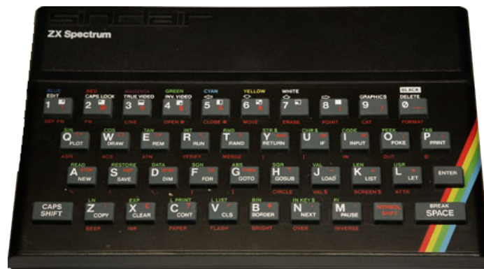
Figura 2.2: Sinclair ZX Spectrum (1982). Uno de los microordenadores domésticos de 8 bits más populares de los años 80
