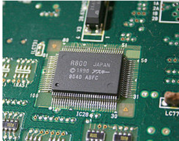
Figura 3.9: Fotografía de una CPU R800 en un MSX Turbo-R
