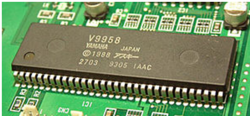
Figura 3.7: Fotografía de una GPU Yamaha V9958 en un MSX2+
