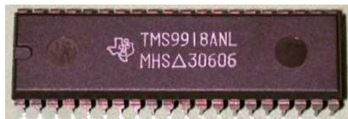
Figura 3.3: Fotografía de un chip Texas Instruments TMS9918
