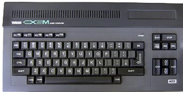
Figura 2.5: Yamaha CX5M (1984). MSX fabricado por Yamaha Corporation que incorporaba un módulo sintetizador FM de ocho voces
