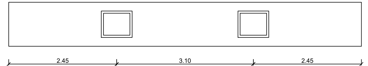
UBICACIÓN APOYOS SOBRE ESTRIBOS ESCALA 1:50
