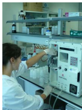
Figura 22: Salinómetro (conductímetro de inducción) para determinar la salinidad de las muestras.
