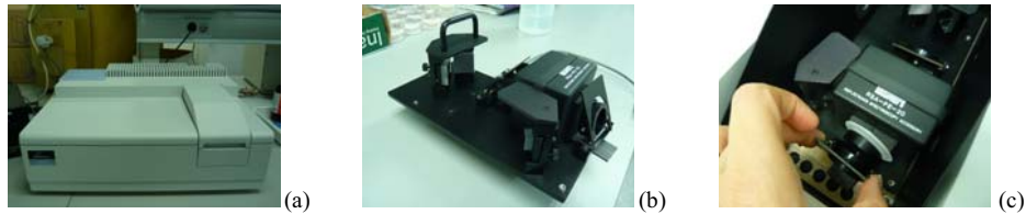
Figura 21: a) Espectrofotómetro UV/Visible utilizado en la determinación de Clorofila a y espectros de absorción. b) Esfera integradora Labsphere RSA-PE-20 c) Medida del espectro de absorción del material retenido en la membrana colocando ésta en la esfera integradora.
