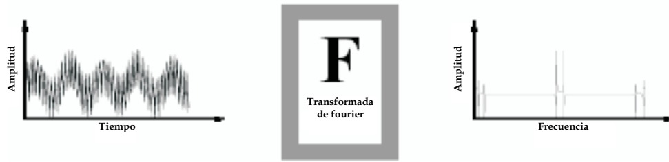
Figura 2.1: Esquema de transformación de la transformada de Fourier.
