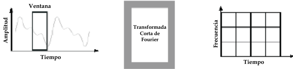
Figura 2.2: Esquema de transformación de la transformada de Fourier por intervalos (STFT).
