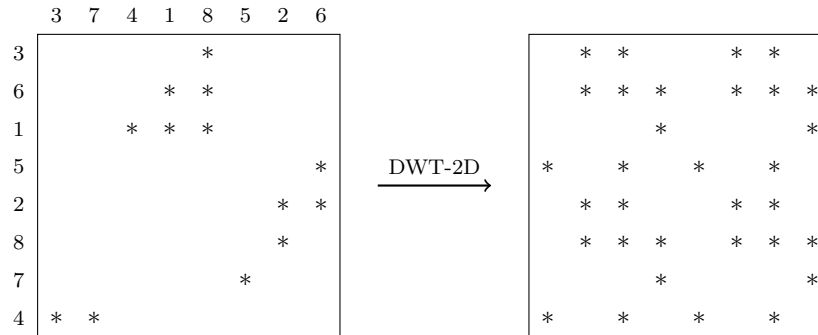
Figura 4.5: Ejemplo de relleno al aplicar la DWT 2D a una matriz dispersa usando un filtro Haar permutando los elementos de la matriz original a una configuración más conveniente.
