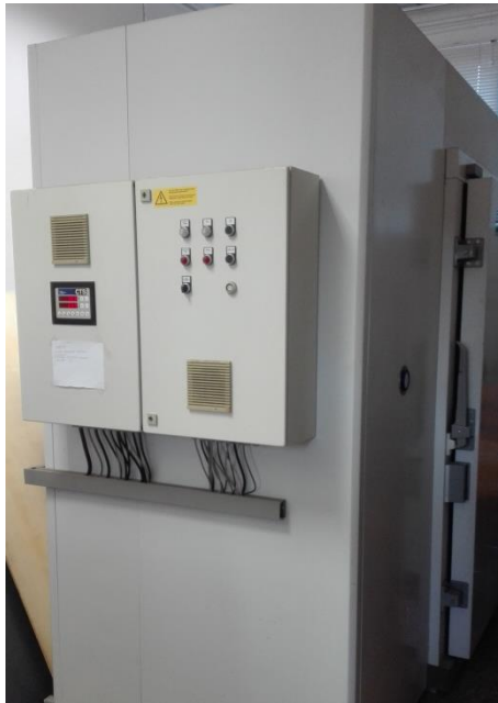
1.28. Cámara climática situada en el laboratorio de electroquímica.
