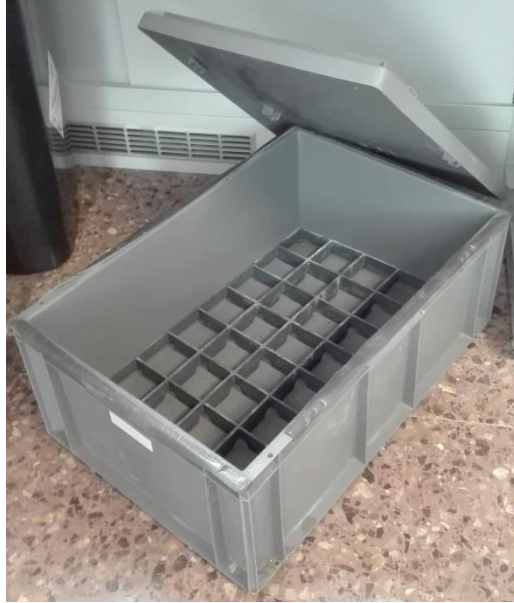
1.27. Recipiente hermético y rejilla para realizar en ensayo a largo plazo.
