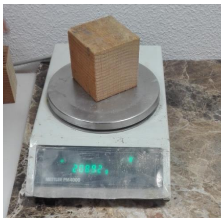
1.16. Balanza de precisión utilizada durante todo el proceso de ensayo del proyecto.
