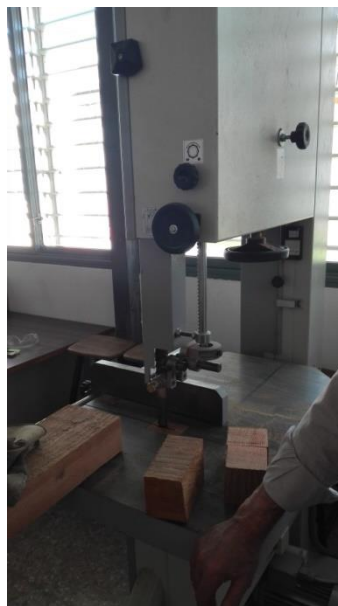
1.15. Sierra de cinta para madera en el momento del corte y confección de las piezas.
