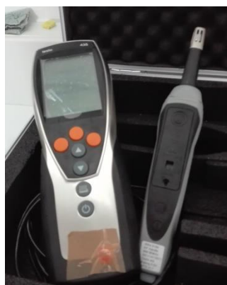
1.23. Testo 435 utilizado para medir la temperatura y la humedad durante el ensayo a corto plazo.
