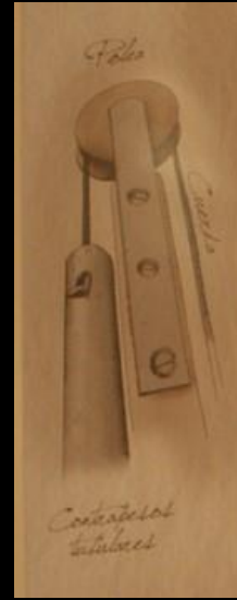
Fig. 46: finestres de guillotina de l'edifici "el Capricho" de Gaudí amb un sistema de tubs que emet notes musicals al practicar les fulles.
