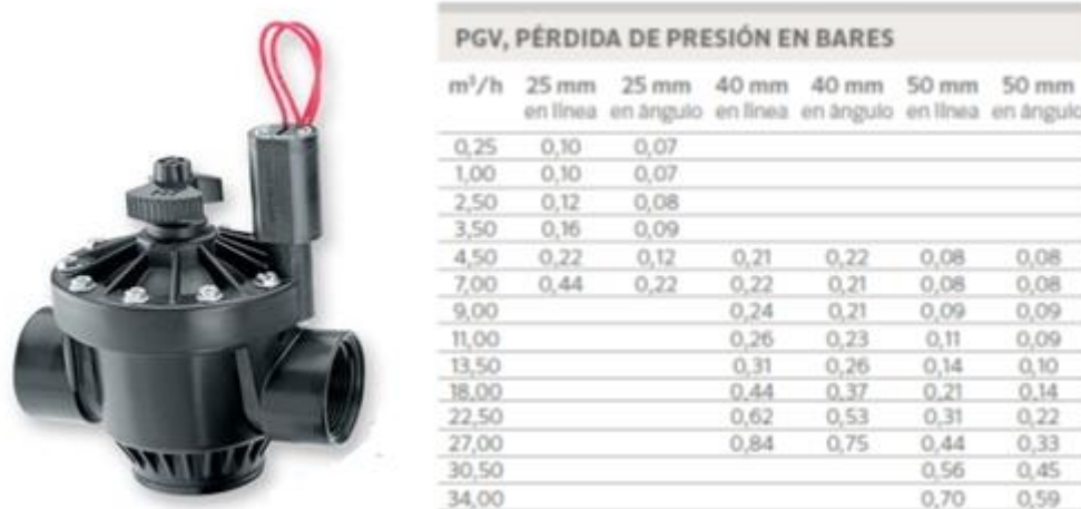
Figura 5.10. Válvula tipo y características técnicas
