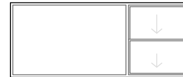
V5 fijo lateral + 2 hojas de guillotina carpintería aluminio anodizado vidrio climalit seguridad 6+6+(3+3)
