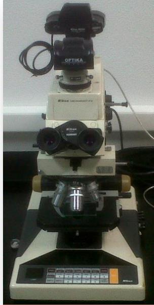
**Figura 19. Microscopio óptico binocular.**
