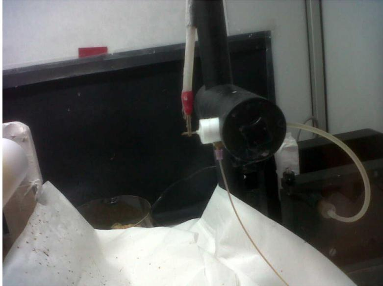
**Figura 38. Sustancia pegajosa en el extremo del capilar la cual dificultaba el proceso de electrohilado.**
