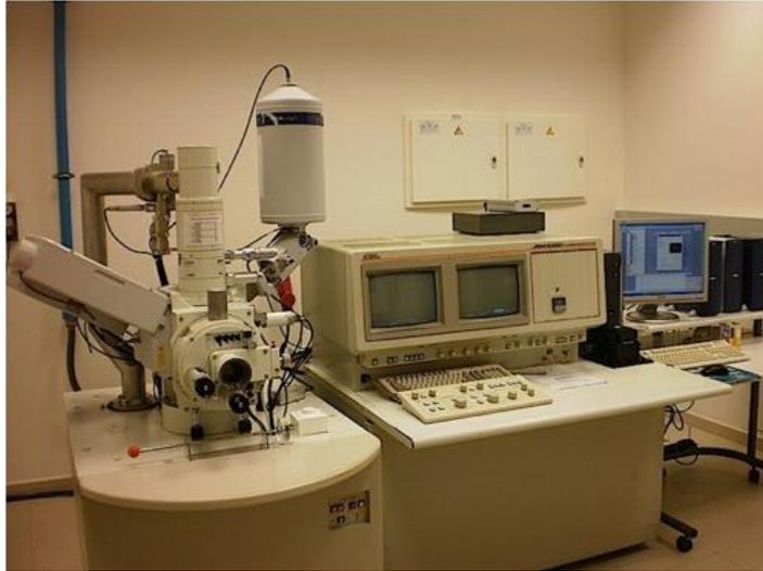
Figura 17. Microscopio Electrónico de Barrido.
