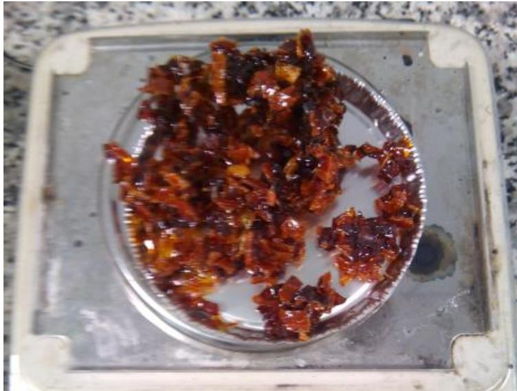
Figura 35. SPEEK tras proceso de secado final.
