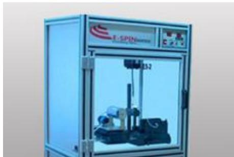
**Figura 10. Cámara que alberga todo el proceso de electrohilado garantizando la seguridad del usuario y del sistema.**
