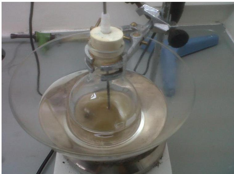
Figura 37. Etapa final de obtención de la solución SPEEK/PVB en DMAc.
