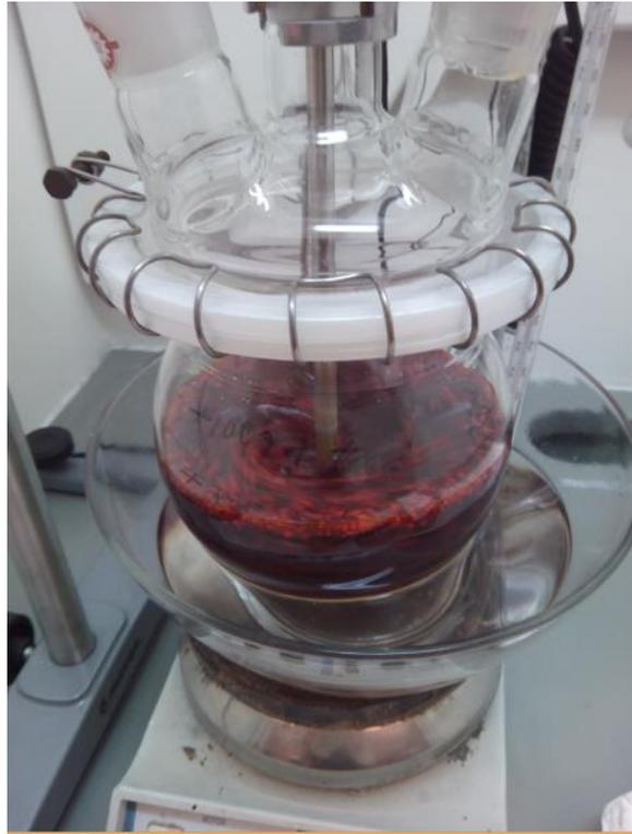
**Figura 30. Mezcla de ácido sulfúrico y PEEK con temperatura.**
