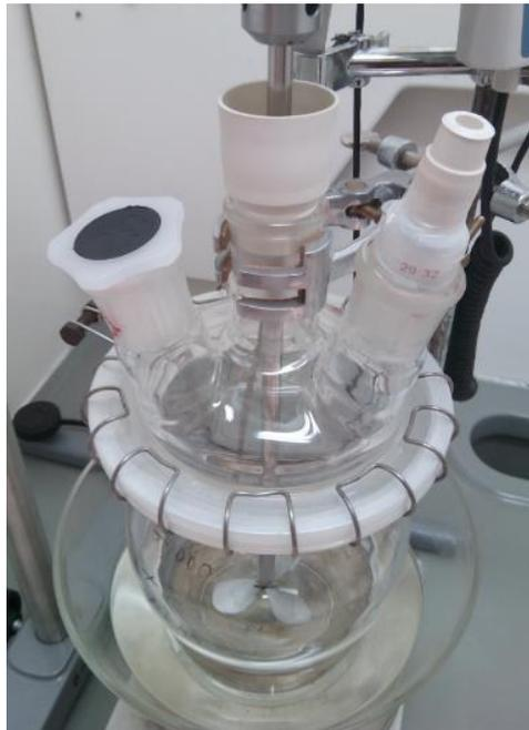
**Figura 29. Adición de ácido sulfúrico y aporte de temperatura.**
