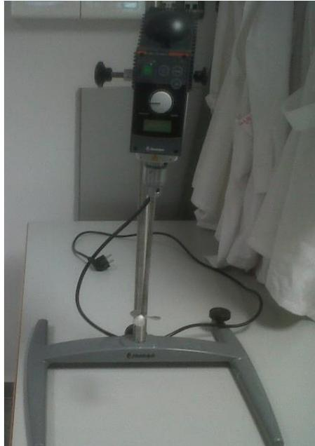
**Ilustración 1. Agitador mecánico de varilla.**
