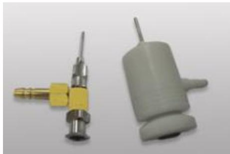
**Figura 8. Capilar (izquierda, electrohilado de una única solución polimérica; derecha, capilar con acople lateral para segunda disolución polimérica para operar en modo coaxial.**
