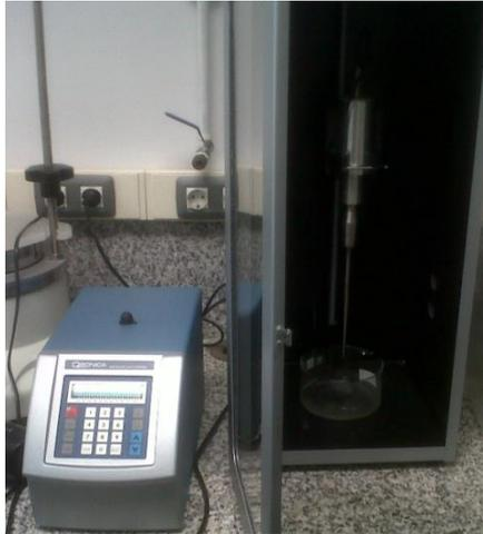
Figura 20. Ultrasonidos con punta de acero.
