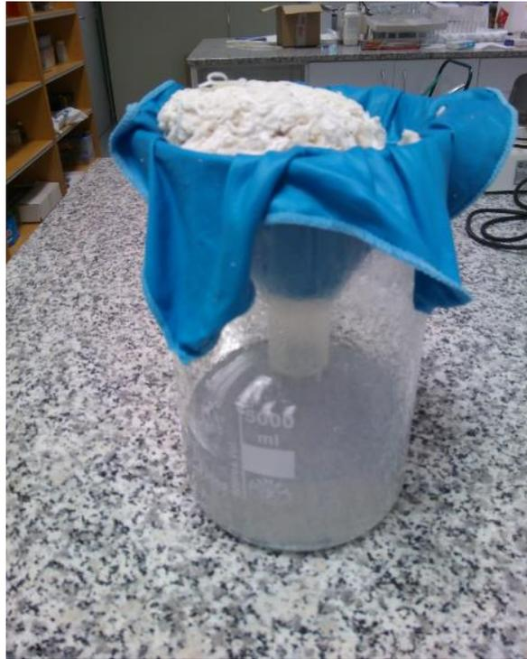
Figura 33. Proceso de lavado de los hilos de SPEEK con agua desionizada.
