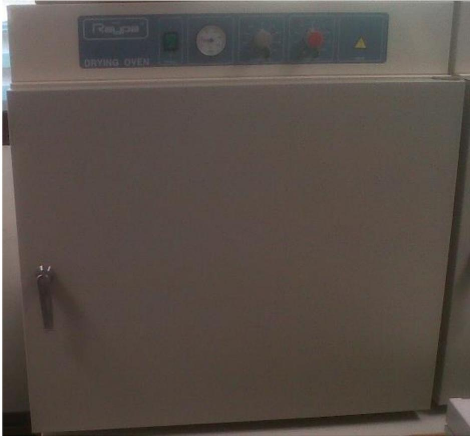
**Figura 23. Estufa de secado analógica.**
