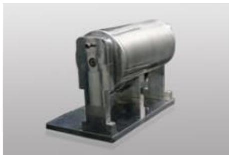
**Figura 11. Contraelectrodo colector de metal del manto de fibras poliméricas formado.**
