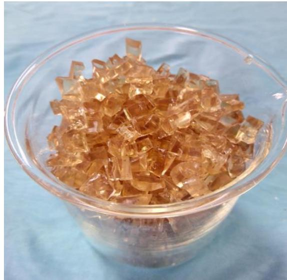
Figura 34. Obtención final de SPEEK tras presecado.
