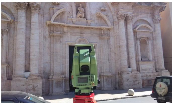
*Ilustración 0.6 Estación total empleada para la medición*
