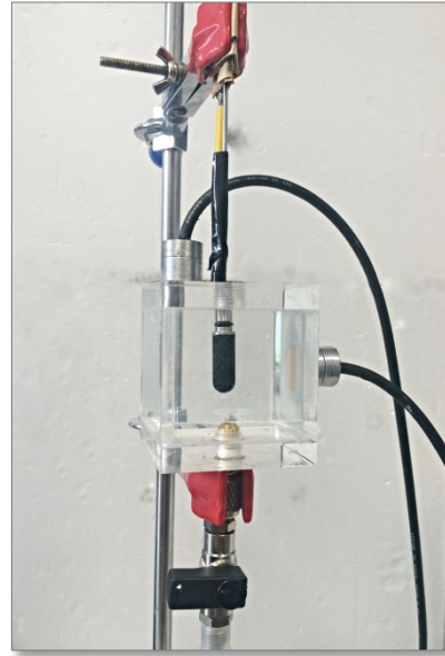
Fig. 58. Sensores pegados: medida con hidrófono RESON TC4013.
