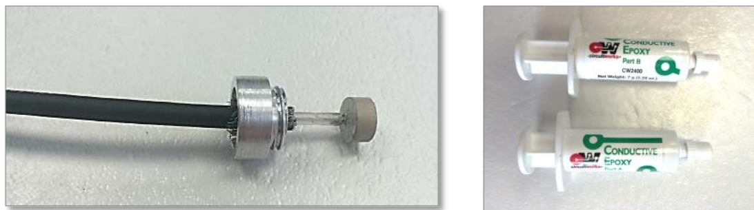
Fig. 35. Cable coaxial pegado al polo positivo de la cerámica con epoxy conductor.
