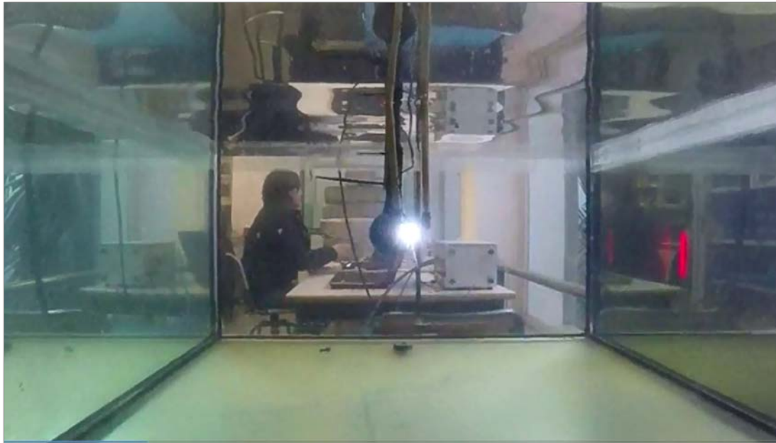
Fig. 45. Ejemplo de generación de chispa dentro del tanque.
