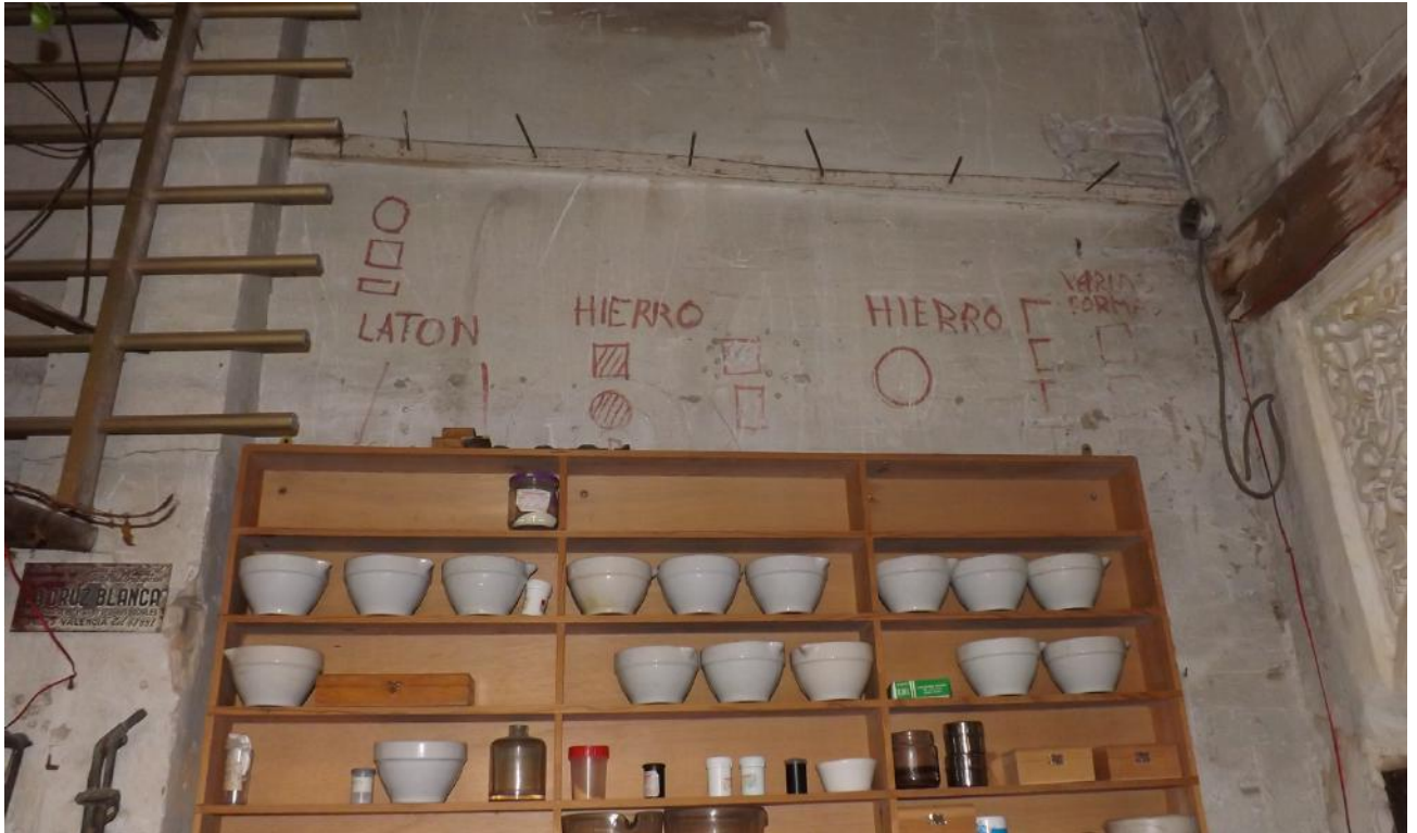
Lámina 15: Fotografía en la que se aprecia la pared en la que antiguamente se colgaban las barras con las que se trabajaba, clasificadas por tipo de sección y de metal. Actualmente se halla puesta en su lugar una estantería que alberga piezas cerámicas. Todavía permanecen los clavos de sujeción anclados a la pared. Fuente: propia. Taller Familia March (Valencia). 2016.
