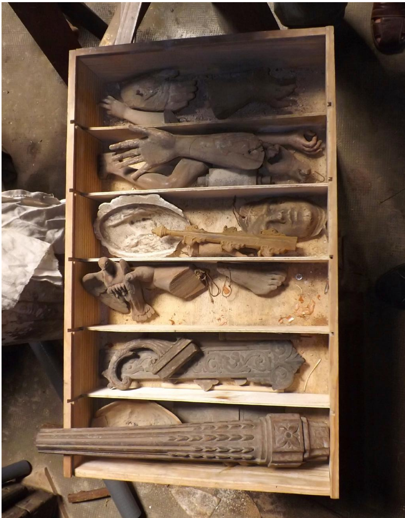
Lámina 24: Moldes de madera para creación de aldabas y piezas huecas. Taller Familia March (Valencia). 2016.
