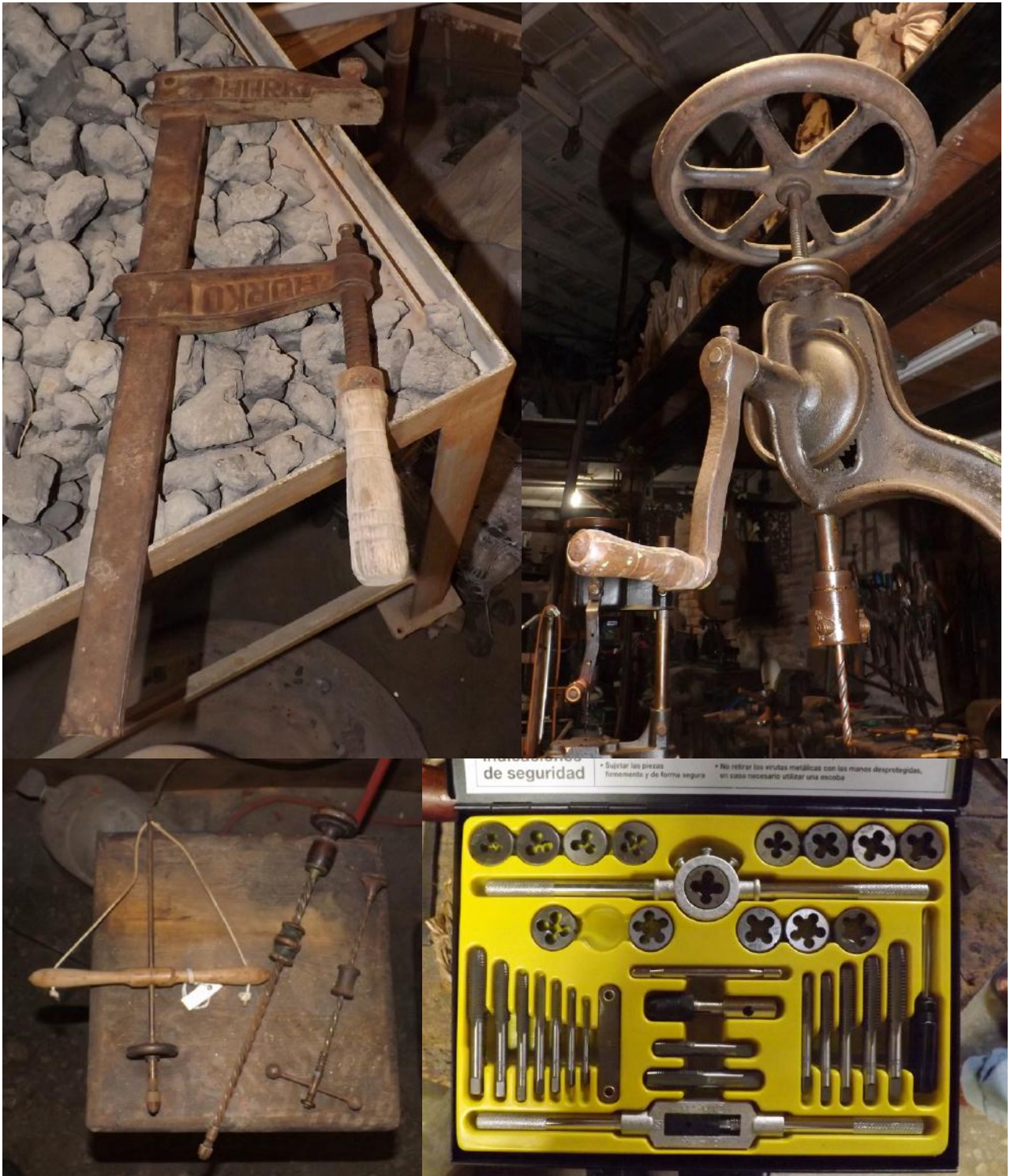
Lámina 22: Garra, taladradora manual, taladros de arco y caja de terraja e hilera actual. Taller Familia March (Valencia). 2016.
