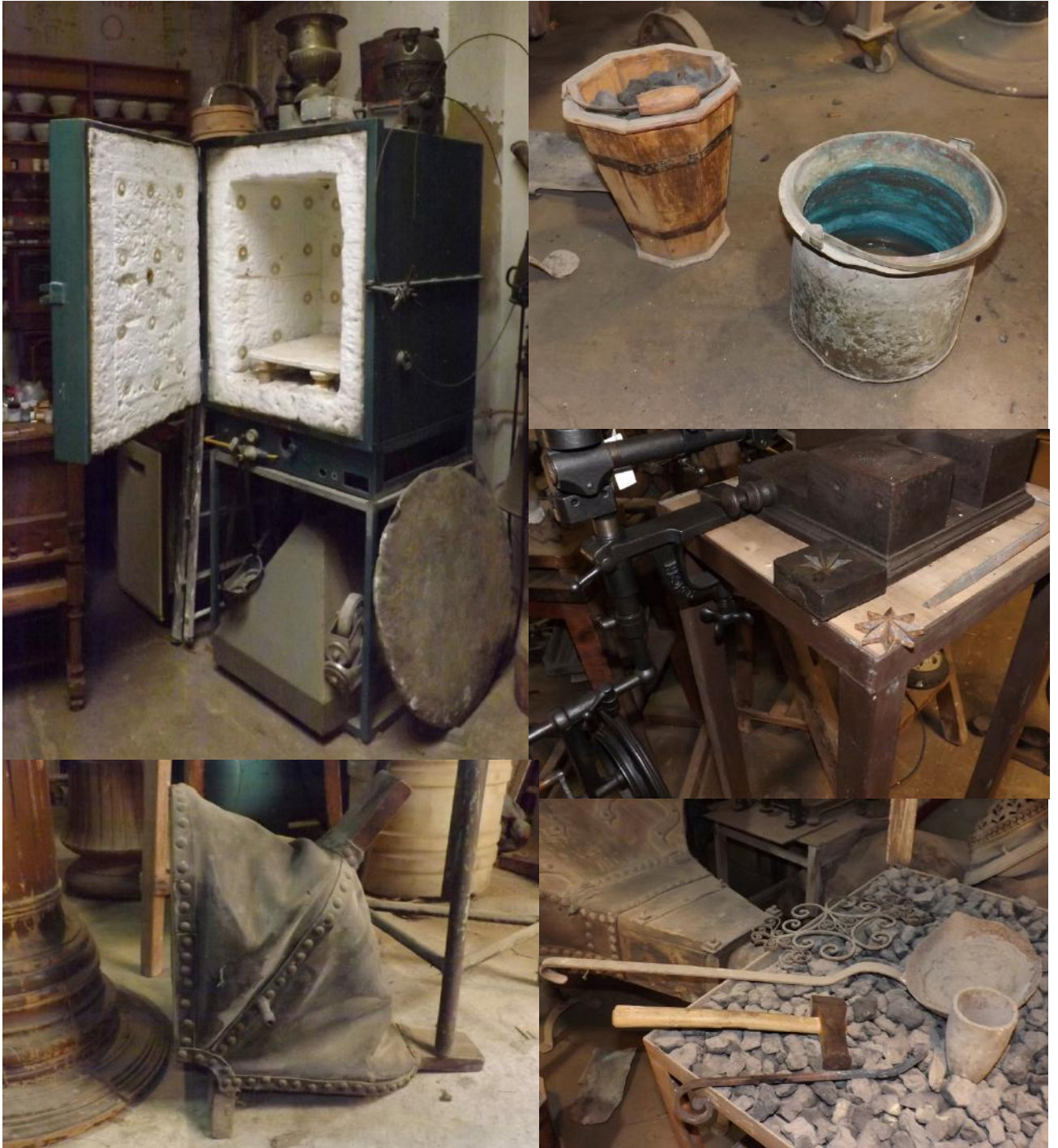
Lámina 23: Horno de gas sin mufla, cubos, estrella elaborada en prensa de metales, pequeño fuelle de pie y espumadera con crisol y martillo de fragua. Taller Familia March (Valencia). 2016.
