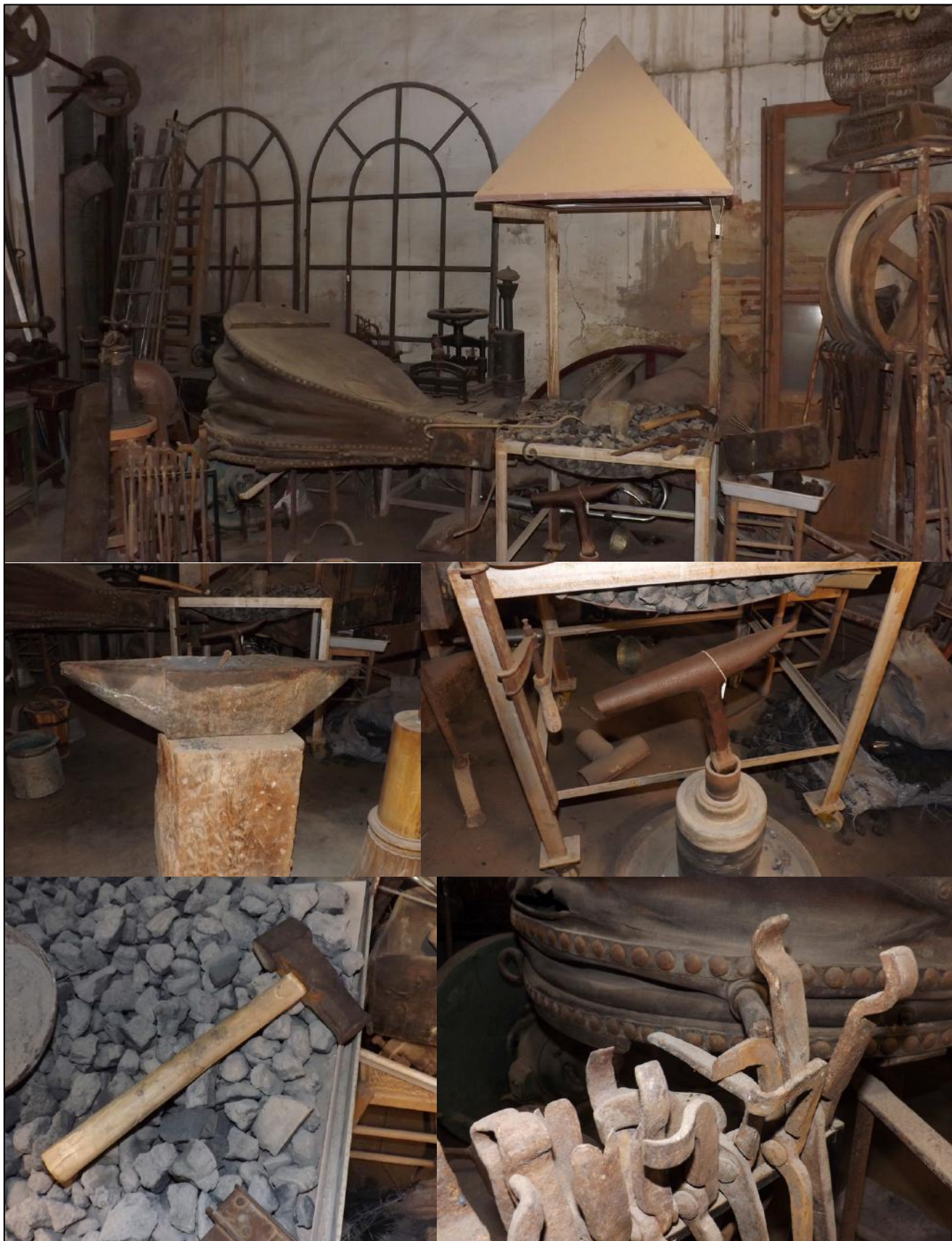
Lámina 20: Fragua, yunque, bigornia, martillo de fragua y tenazas. Fuente: propia. Taller Familia March (Valencia). 2016.
