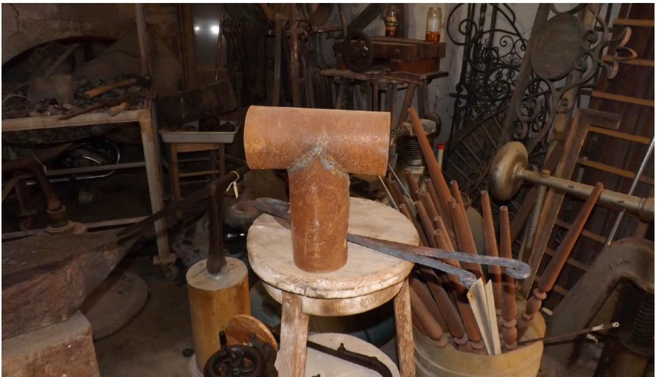
Lámina 16: Manguito en forma de "T", propia del oficio del "calderer" valenciano. Fuente: propia. Taller Familia March (Valencia). 2016.
