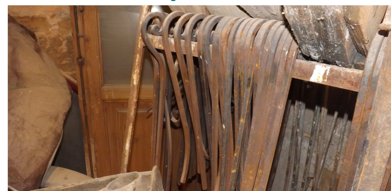
Barras para elaboración de barandilla de balcón
