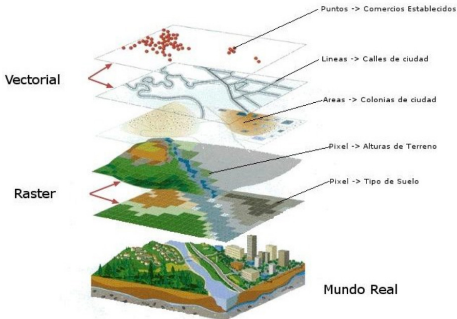
Ilustración 26. Esquema de funcionamiento de un SIG. https://nhdlibre.files.wordpress.com
