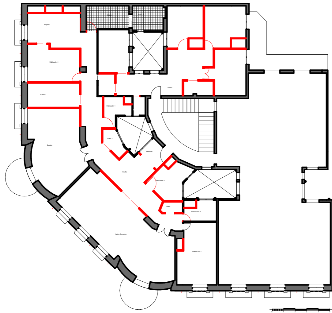
Fase Nueva Construcción
