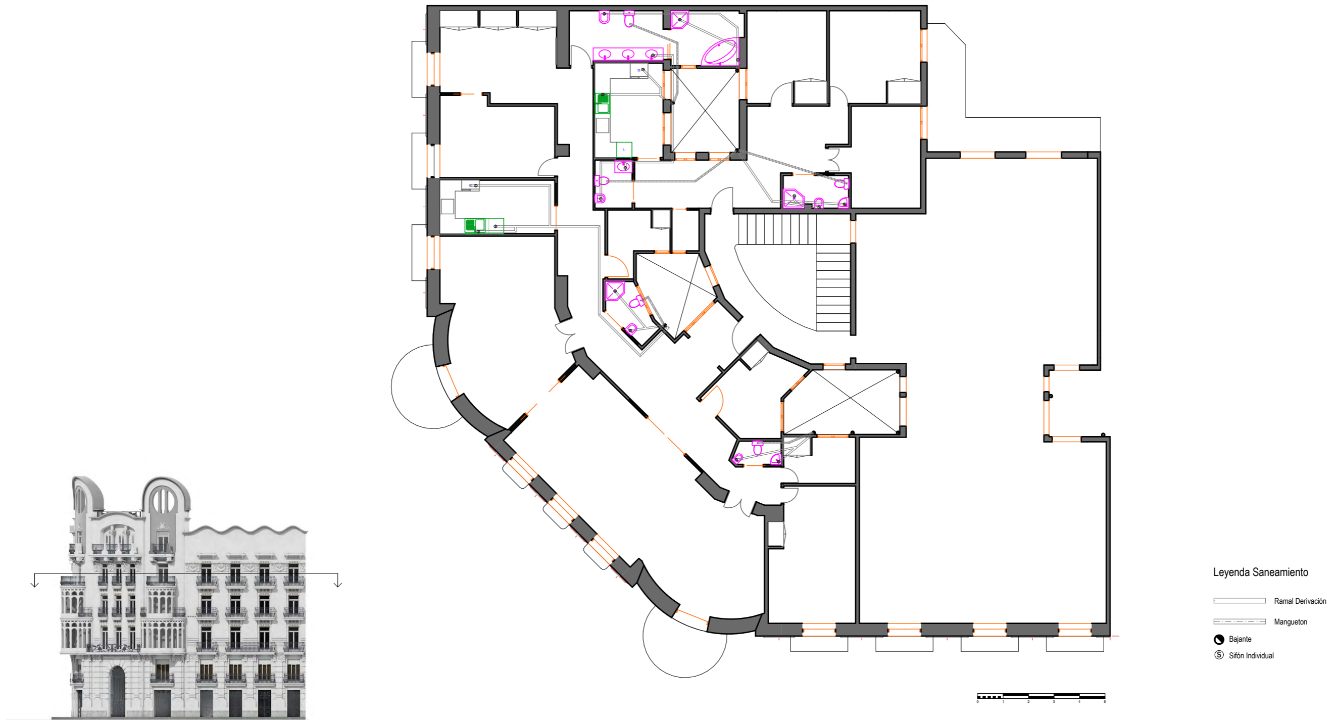
Plano Instalación Saneamiento Planta Cuarta
