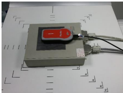
Figura 6. Medida de la dosis y del HVL utilizando el detector Piranha.
