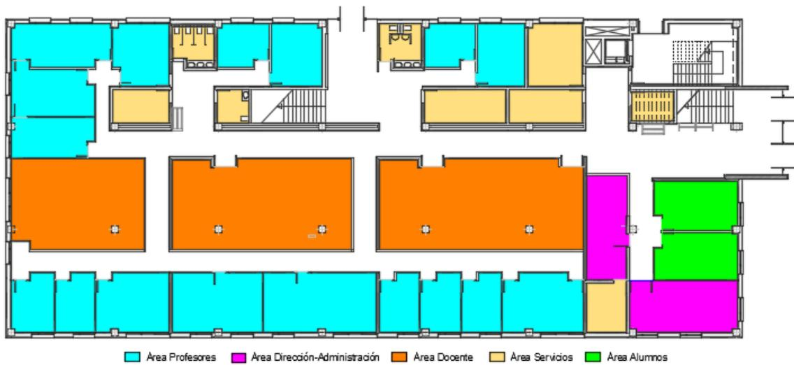
Figura 5: Esquema funcional Planta Baja. Figura extraída del plano 36.
