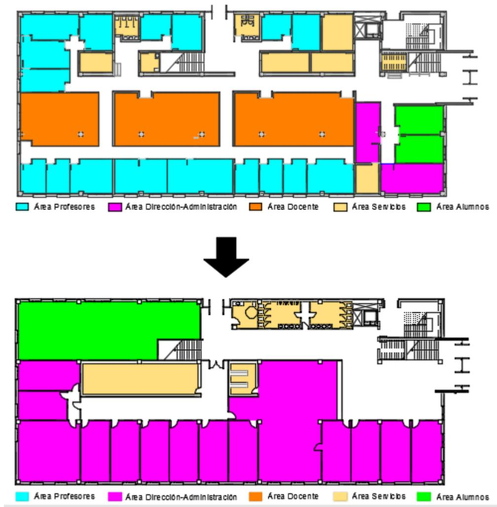
Figura 46: Comparación estado actual-propuesta Planta Baja. Figura extraída del plano 36 y 52
