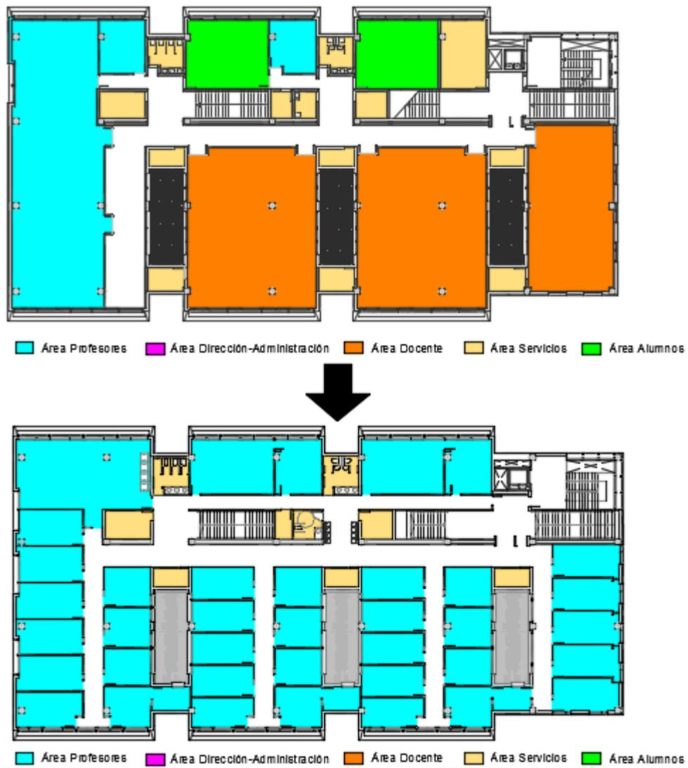
Figura 47: Comparación estado actual-propuesta Planta Primera. Figura extraída del plano 37 y 53.
