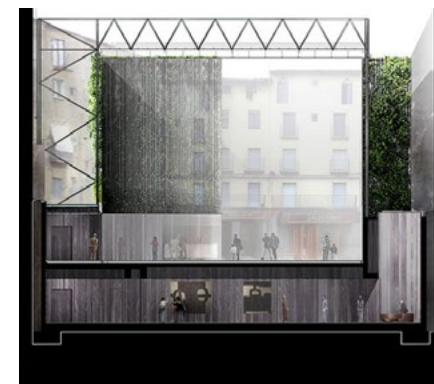
Figura 27. Sección general del proyecto. RCR Arquitectes. 2004
