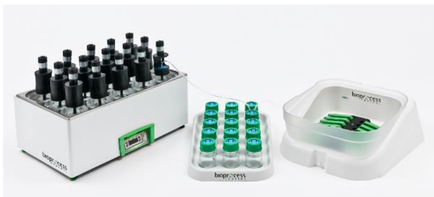
Ilustración 11. Equipo AMPTS II de Bioprocess Control. De izquierda a derecha, unidad de incubación, unidad de fijación de gases y unidad de medida
