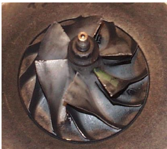
Figura 2.5.5 Alabes de turbocompresor dañados por el fenómeno de bombeo.
