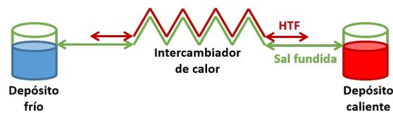
Figura 2.4: Esquema de funcionamiento del subsistema de almacenamiento
