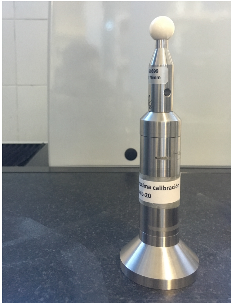
Figura 16: Útil de calibración de ángulos. Fotografía de elaboración propia.
