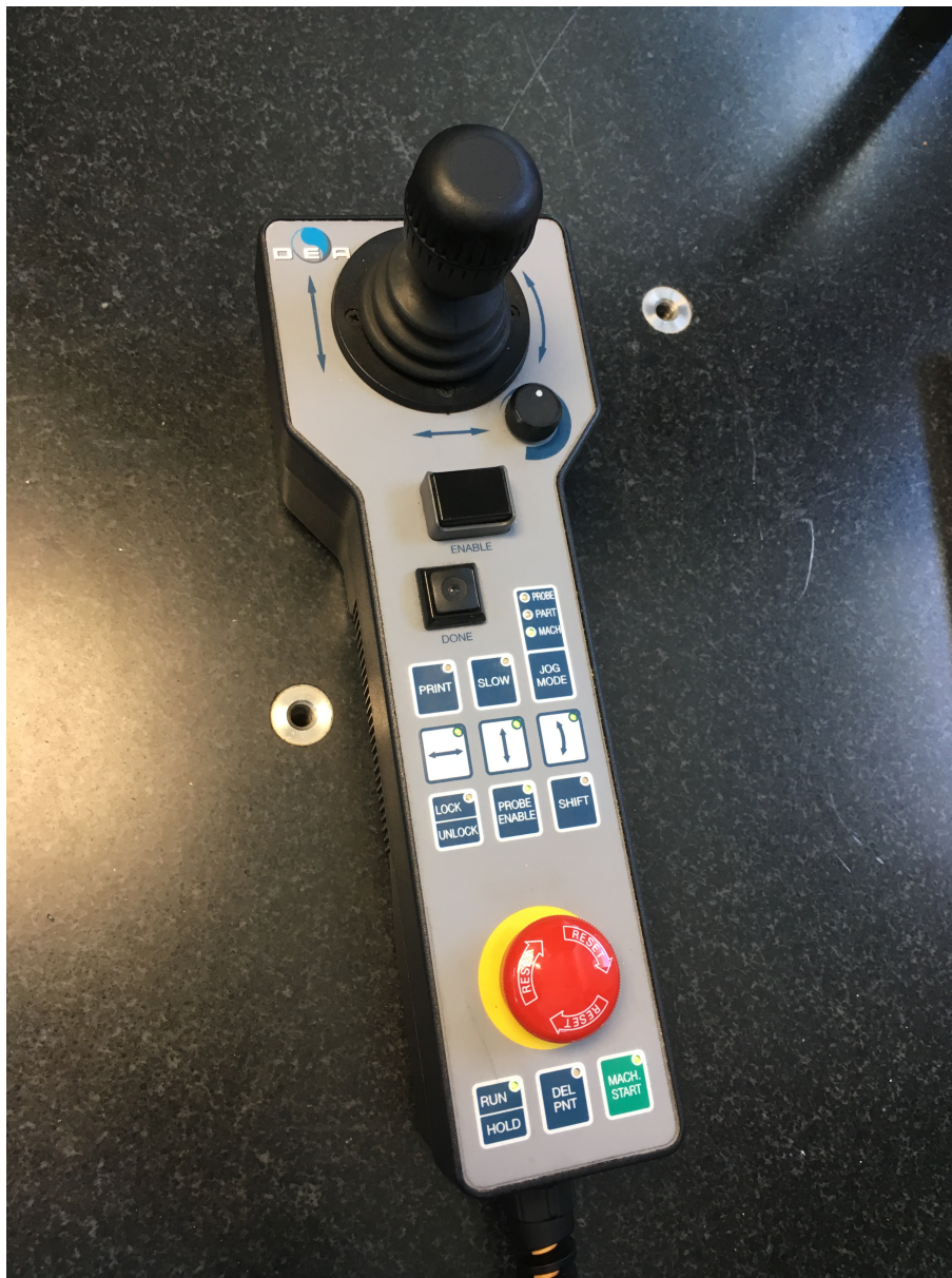
Figura 15: Controlador de la máquina CMM. Fotografía de elaboración propia.
