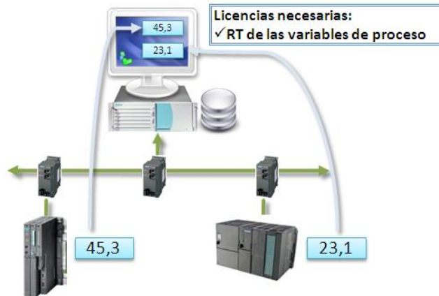
Figura 1.8 : Topología del sistema monopuesto
