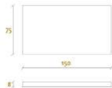
42 | Detalle azulejo de fachada.
