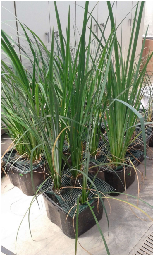
Figura: Módulo de vegetación correspondiente a la Typha latifolia donde se aprecia el sistema de sujeción que confiere flotabilidad a la planta dentro del contenedor estanco.
