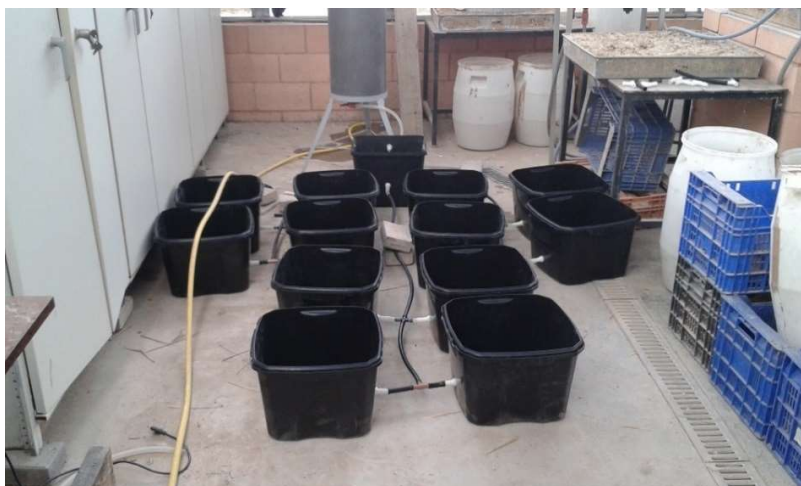
Figura: Línea sin vegetación con depósito de almacenamiento, filtro, contenedores estancos y tubería y conectores de riego por goteo.
