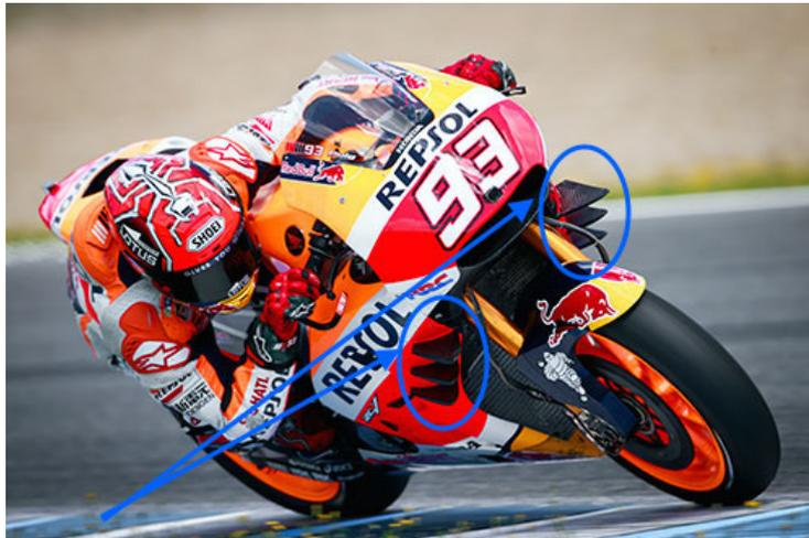
Figura 1.1: Alerones de fibra de carbono en la Honda RC213V.
