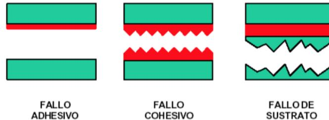
Figura 2.8: Fallos de una unión adhesiva.
