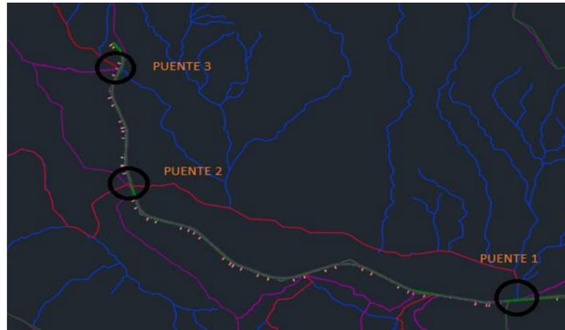
Figura 2.3.2. donde observamos las intersecciones de la carretera con el río Tuéjar y el barranco del Convento (en color rojo vemos el recorrido principal de las cuencas).
