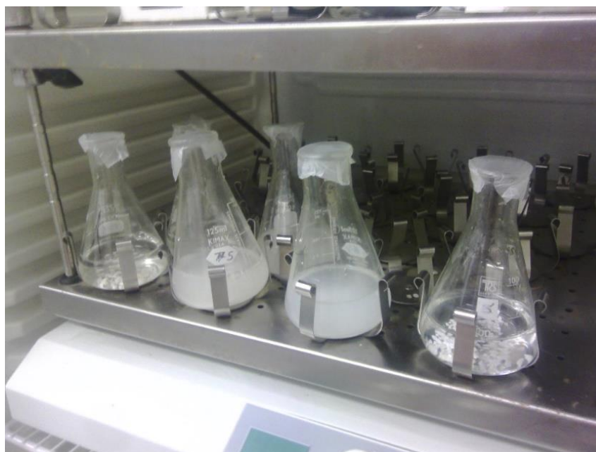
Figura 10: Mostres de l'assaig cinètic en l'agitador
