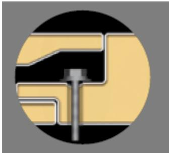
Los paneles se acoplan ocultando la cabeza del tornillo. El cerramiento apoyará sobre la viga de atado.
