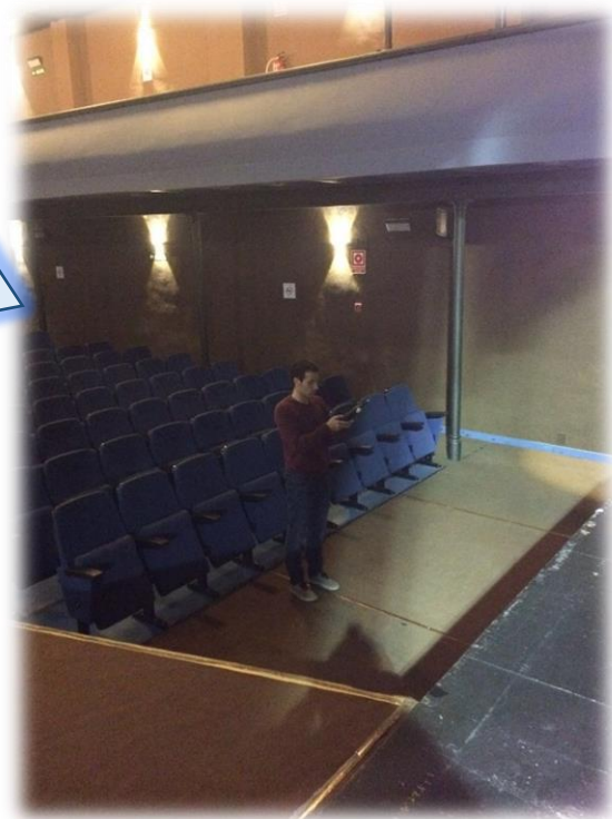
Ilustración 44. Medición "in situ" del Aislamiento.
