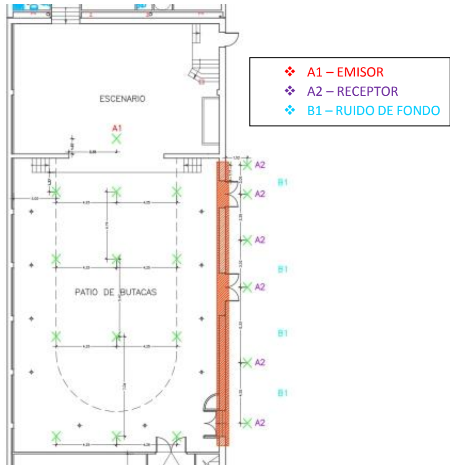
Ilustración 42. Puntos de Medición en Planta Baja.
