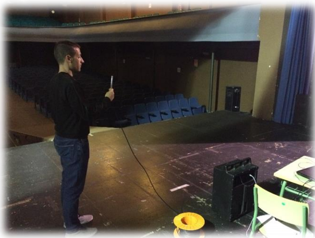
Ilustración 47. Medición "In situ" de Dirac en Escenario.
