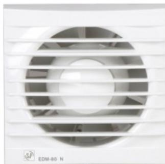
Ventiladores helicoidales con caudal aproximado de 80 m<sup>3</sup>/h, motor 230V-50Hz, IP44 (1), Clase II, con protector térmico, para trabajar a temperaturas de hasta 40°C.
