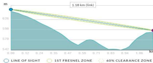
Figura 49 – perfil de elevación entre repetidor radio-Alcoy y el parque la glorieta
