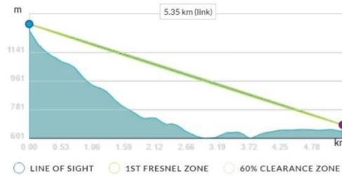
Figura 46 - Grafico de perfil de elevación entre nodo principal y depósitos de agua
