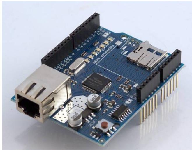
Figura 4 - add-on auxiliar para proveer a la placa Arduino de conectividad Ethernet
