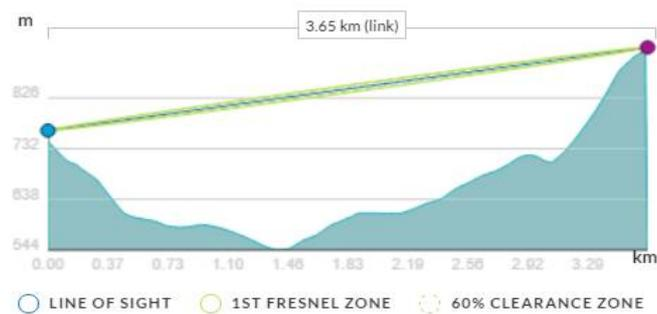
Figura 24 – perfil elevación segundo enlace
