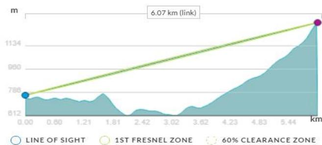
Figura 23 – perfil elevación primer enlace
