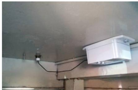
Figura - 9 detalle del interior de un contenedor con el sensor de ultrasonidos
