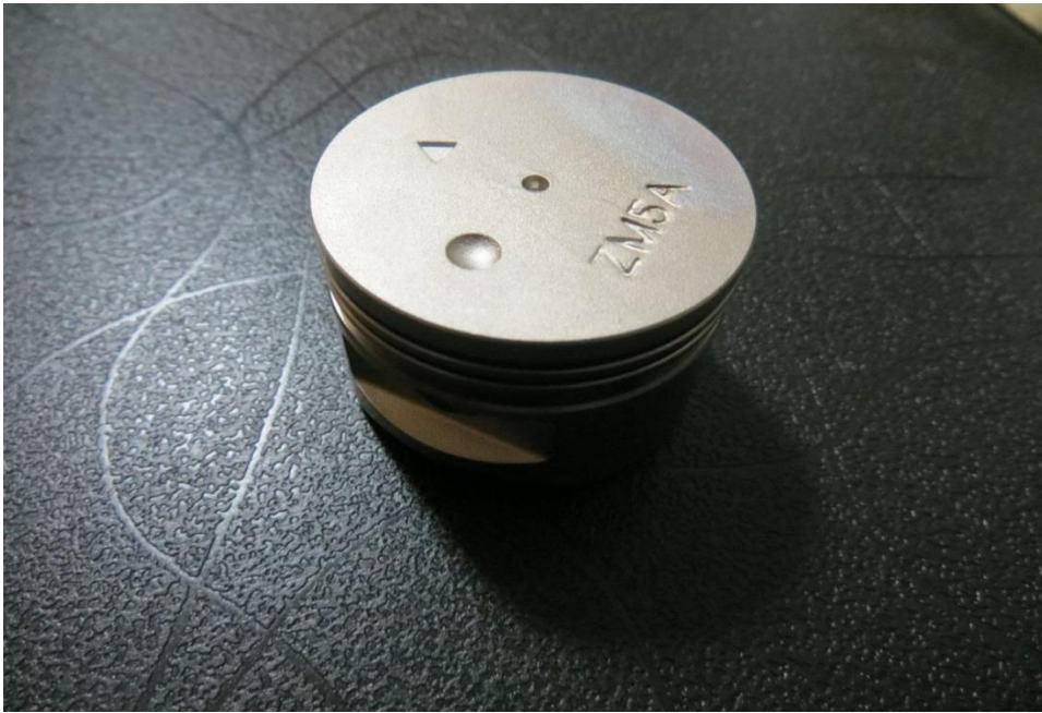
Pistón del motor GX31
