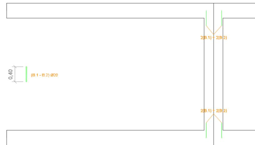
Figura 53 Detalle unión riostra - arco
