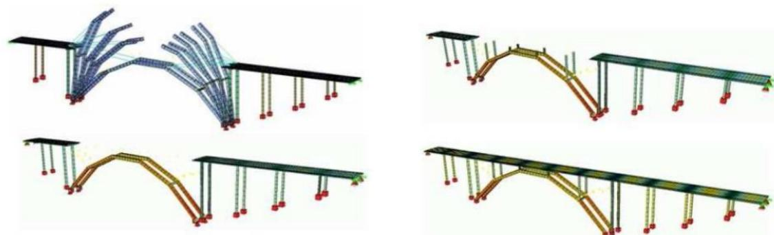
Figura 15 Proceso constructivo del arco del vano central [Reichel et al. 2009]
