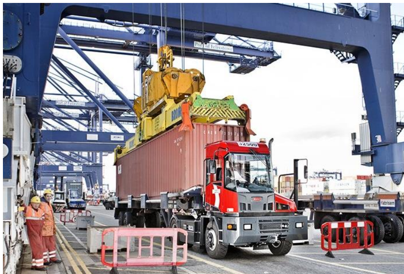
Figura 77. Tractor de terminal con plataforma siendo cargado. Fuente: Kalmarglobal
