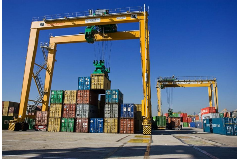
Figura 76. Grúa RTG. Fuente: Konecranes
