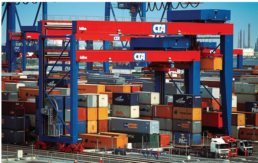
Figura 39. Grúas ASC pasantes (DRMG). Terminal CTA Puerto de Hamurgo. Fuente: porttechnology
