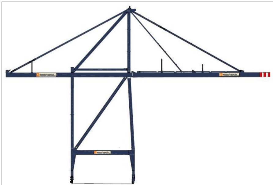
Figura 44. Grúa Portainer Malaccamax. Paceco España SA. Fuente: Paceco
