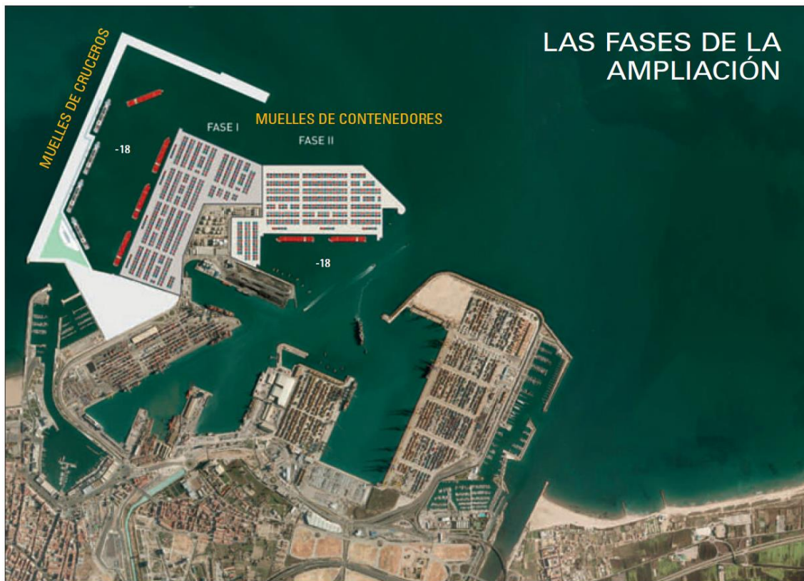
Figura 31. Fases de la ampliación norte del Puerto de Valencia. Fuente: cadenadesuministro.es
