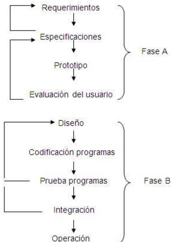
Figura 6 Modelo Prototipo
